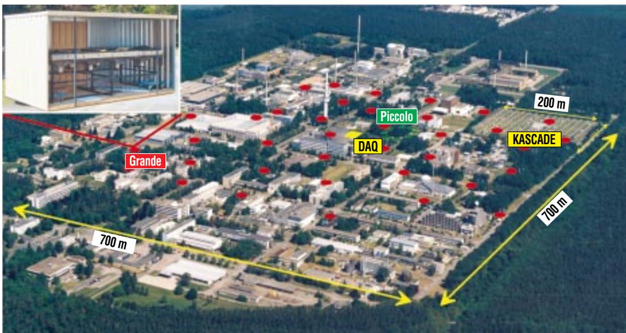
Abb. 6: Das Detektorfeld von KASCADE-Grande im Forschungszentrum Karlsruhe mit Blick in eine der 37 Stationen. KASCADE-Grande besteht aus dem ursprünglichen KASCADE-Experiment, den über das Zentrums-gelände verteilten Grande-Stationen, einer Datenaufnahmestation (DAQ) und einem schnellen Triggerarray (Piccolo).
